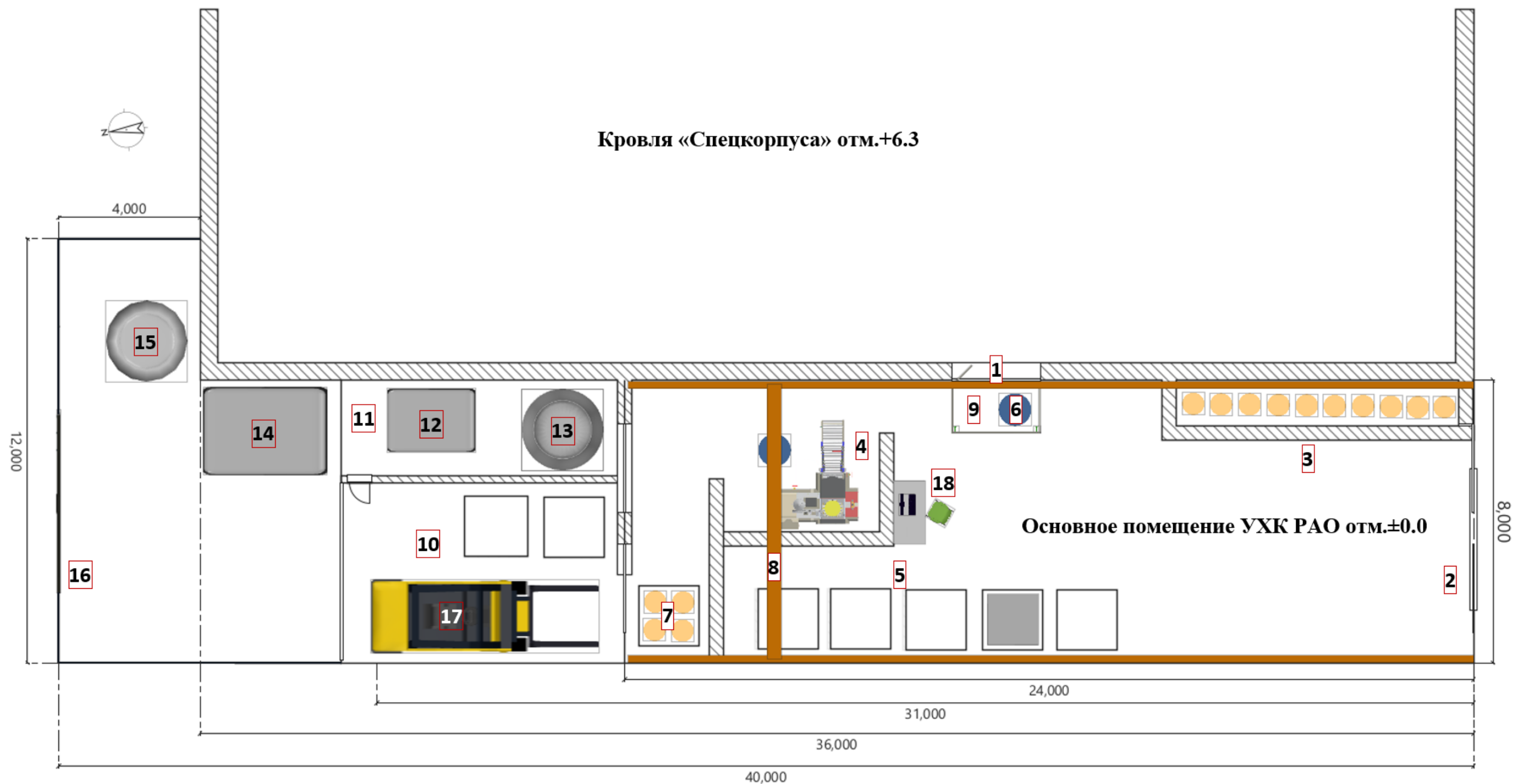
Рисунок ПЗ.2 Предварительная схема компоновки и размещения оборудования УХК РАО
